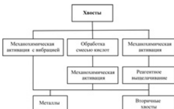
Рис. 3. Схема извлечения попутных металлов из хвостов обогащения методами механохимической активации
