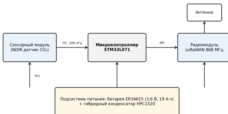
Рисунок 1 – Структурная схема автономного измерительного узла на базе микроконтроллера STM32L071 и трансивера LoRaWAN
