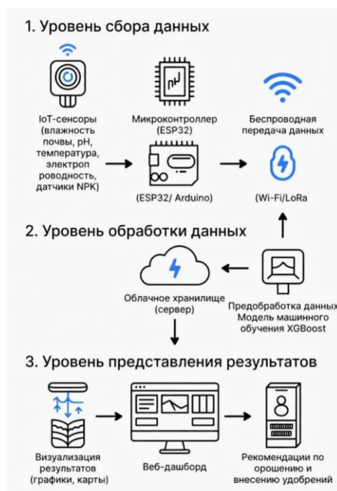
Рисунок 1 – Архитектура автоматизированной информационной системы мониторинга почвы
