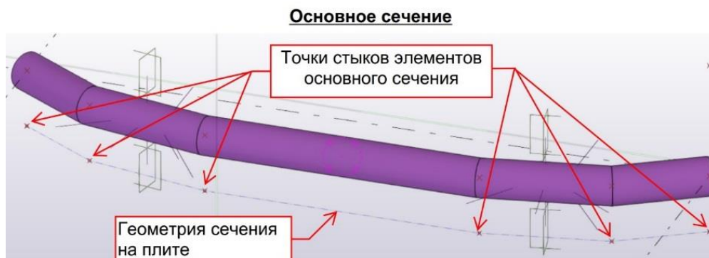
Рисунок 1 – Контроль отклонения конструкции от геометрии на плите
