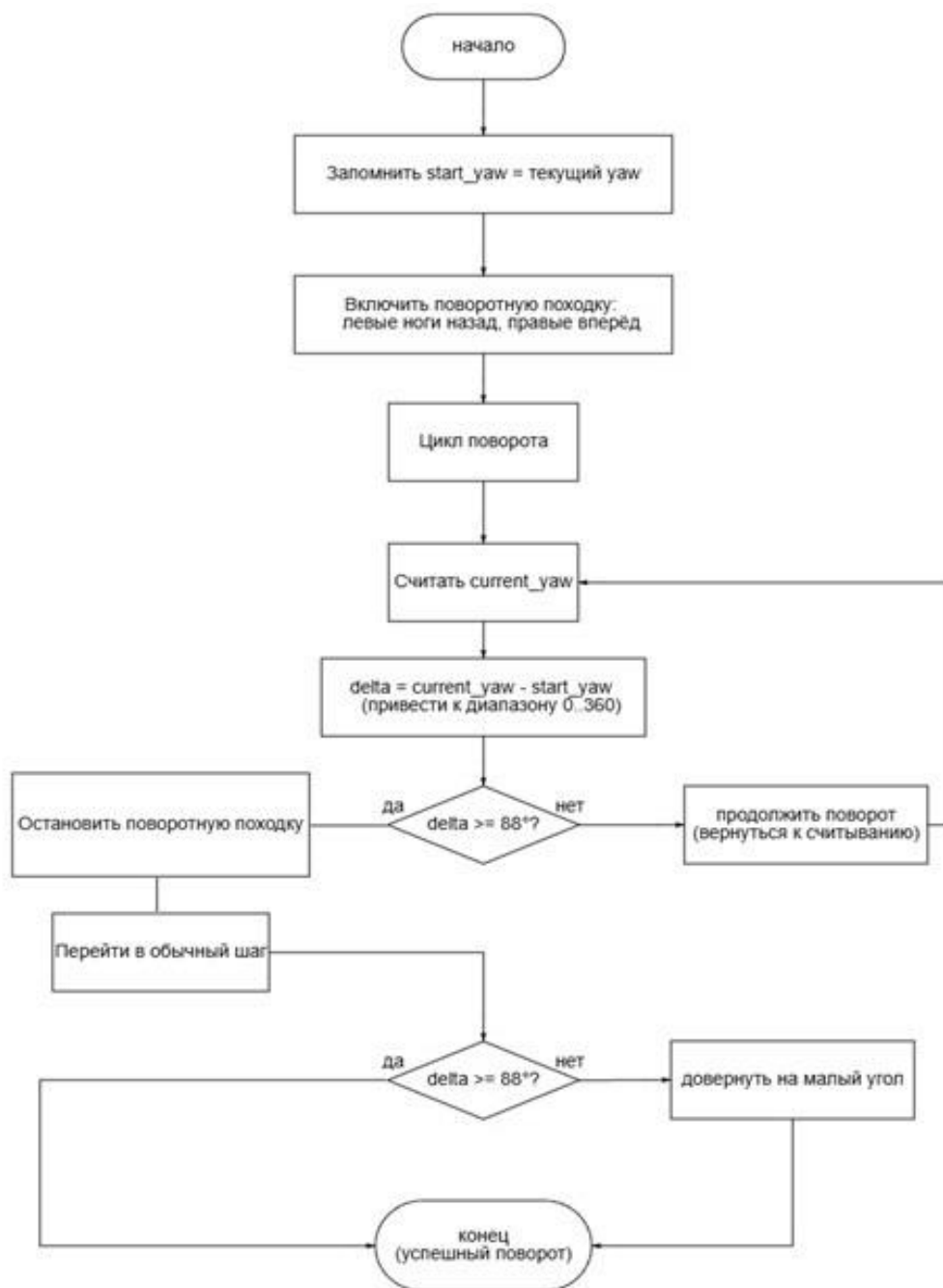
Рисунок 3 – Блок-схема поворота налево на 90^\circ
