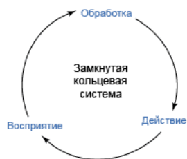
Рисунок 2 – Схема замкнутого цикла взаимодействия робота с внешней средой
