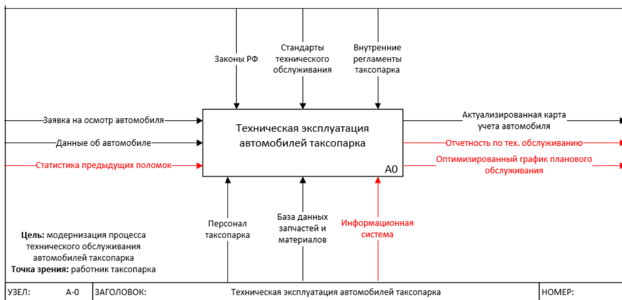
Рисунок 3 – Контекстная диаграмма «КАК БУДЕТ» технической эксплуатации автомобилей таксопарка
