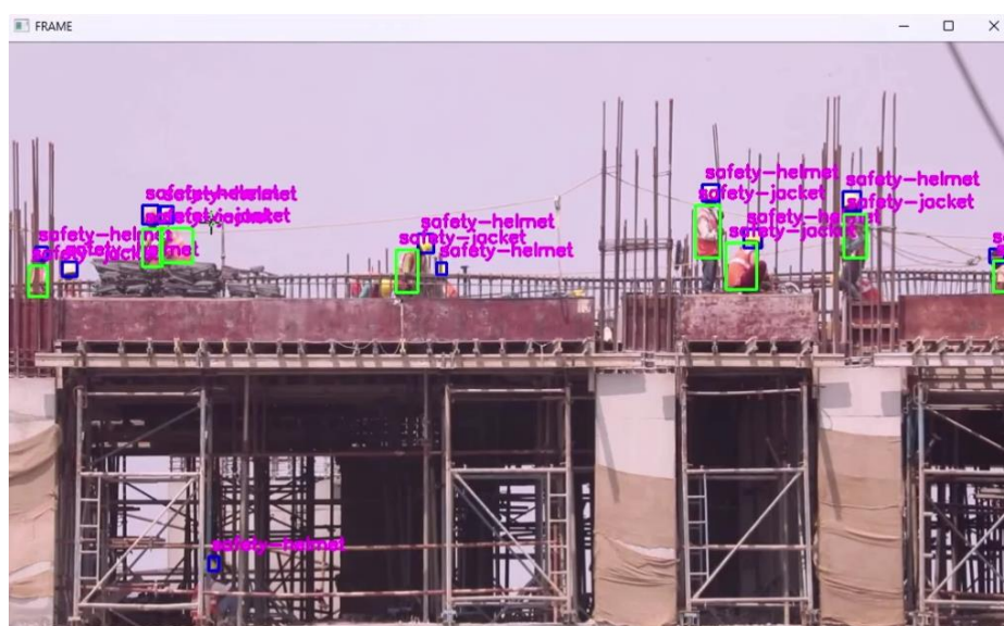
Рис. 2 Пример визуализации детекции на кадре производственного видео YOLOv8s
