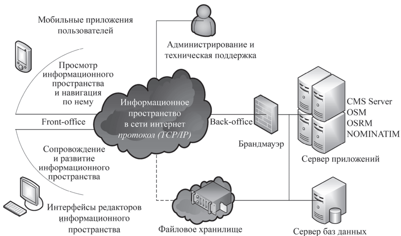
Рис. 3. Логическая схема построения сети сервисов на основе модели информационного пространства
