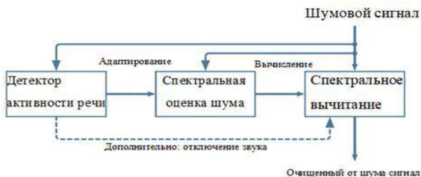
Рисунок 1 – Высокоуровневая структура большинства алгоритмов шумоподавления
