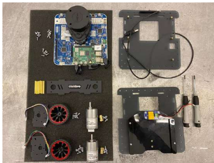
Рисунок 2 – Основные компоненты мобильной роботизированной платформы TurtleBro
