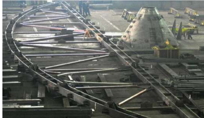
Второй метод (рис. 2) несколько сложнее первого и включает в себя [2]: а) предварительный расчет теоретических (проектных) координат точек, который может быть выполнен либо на основе 3D модели конструкции, либо на основе данных из рабочих чертежей; б) съёмка фактических точек непосредственно на площадке и на конструкции; в) получение отклонений фактических координат от проектных. Отклонение в данном случае рассчитывается как разность между фактической координатой и теоретической (проектной) координатой.
