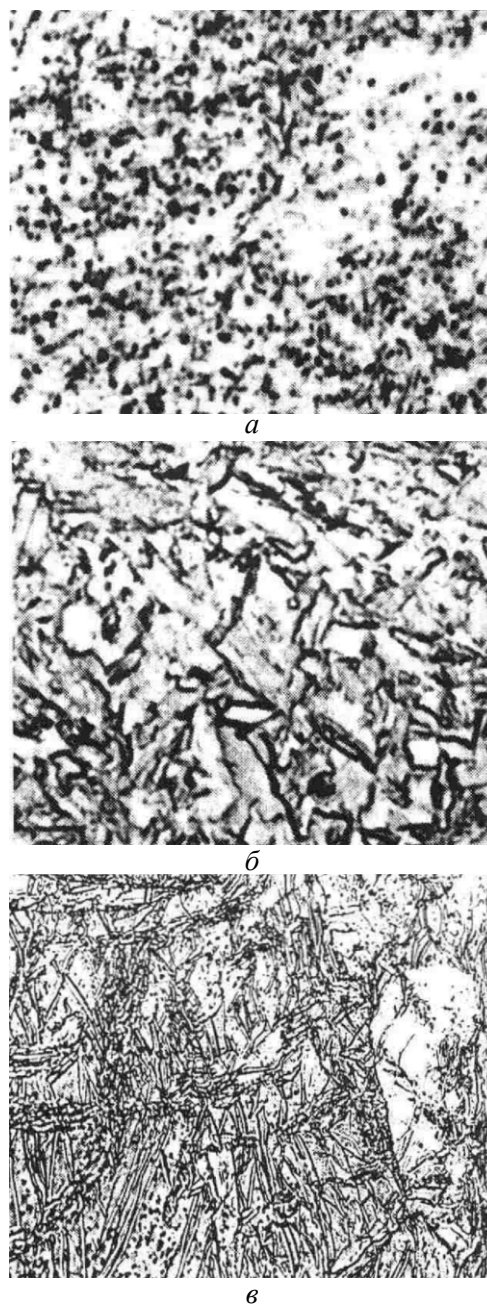
Рис. 3. Микроструктура титана ВТ1-0 после прокатки при 773 К: а — 93%, б — 87%, в — 75%. Увеличение — \times 2000 .
