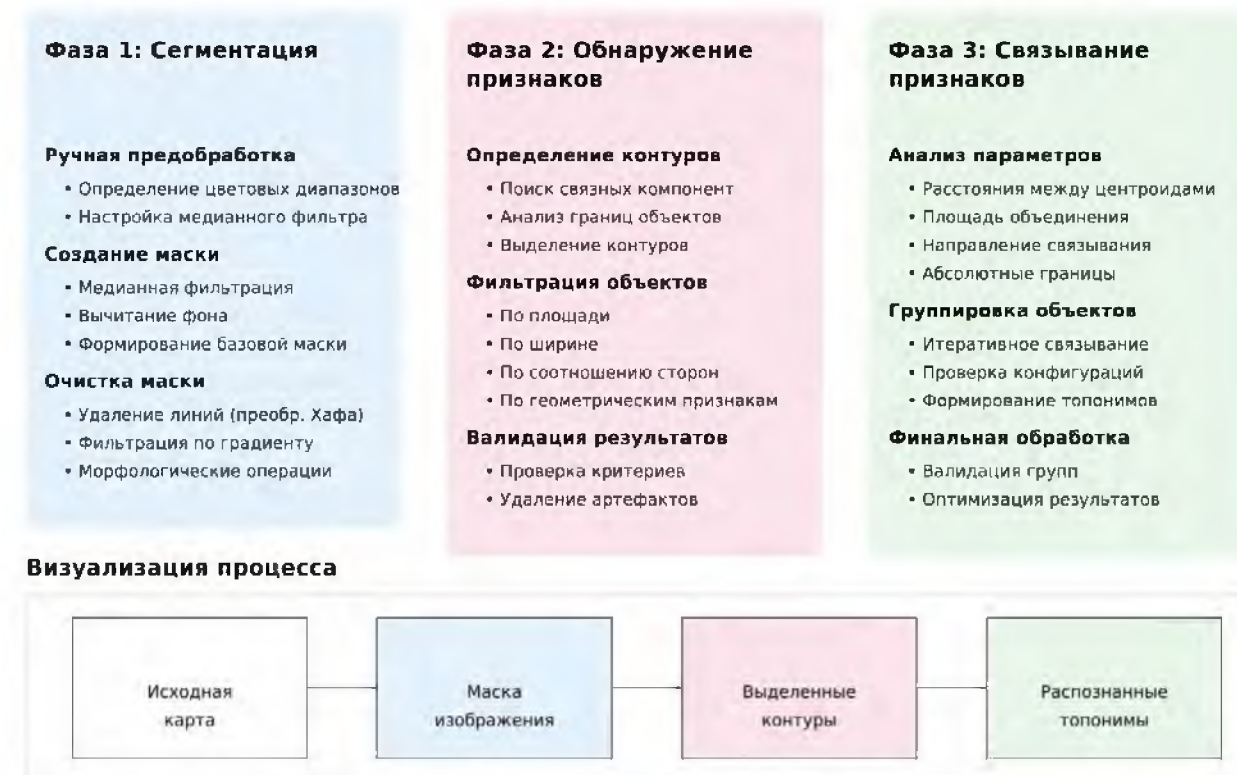
Рис. 4. Трехфазовый подход Р. Саймона и др. [Simon et al., 2014] Fig. 4. Three-phase approach by R. Simon et al. [Simon et al., 2014]
