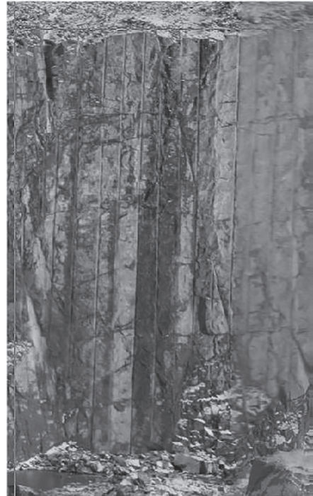
Рис. 1. Фотография откоса уступа, образованного контурным взрыванием в массиве гранитогнейсов с минимальным нарушением горного массива
