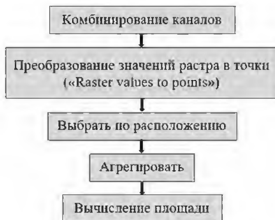
Рис. 4. Схема алгоритма вычисления площади эвтрофикации Fig. 4. Diagram of the algorithm for calculating the eutrophication area
