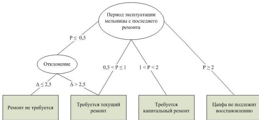
Рис. 3. Оргграф решения выбора вида ремонта Fig. 3. Digraph of the solution for choosing the type of repair
