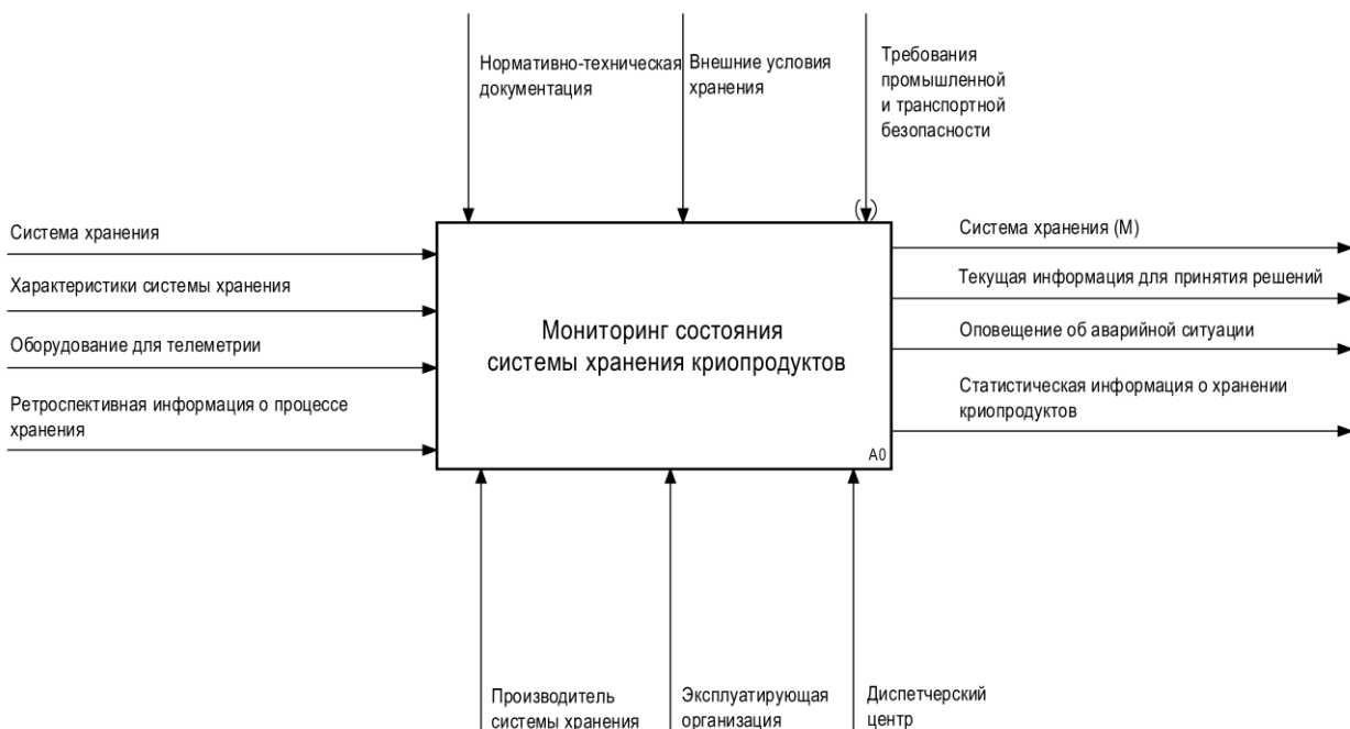
Рис. 1. Контекстная диаграмма функциональной модели мониторинга состояния системы хранения криопродуктов
