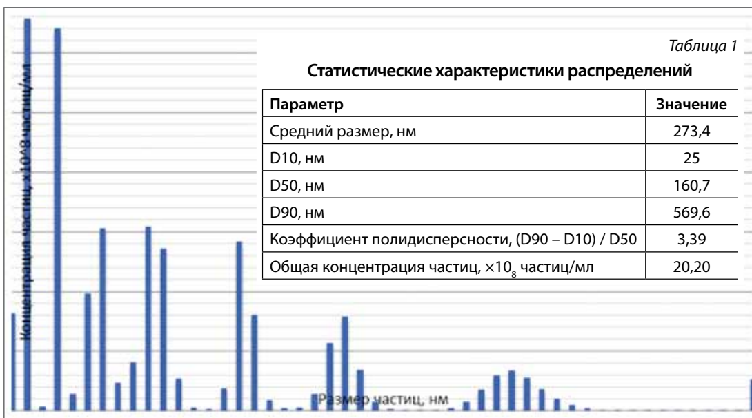
Рис. 2. Распределение частиц по размерам в образце нанокapsул сухого экстракта бадана в альгинате натрия (соотношение «ядро : оболочка» 1:1)
