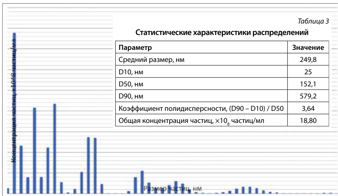
Рис. 4. Распределение частиц по размерам в образце нанокapsул сухого экстракта бадана в альгинате натрия (соотношение «ядро : оболочка» 1:3)
