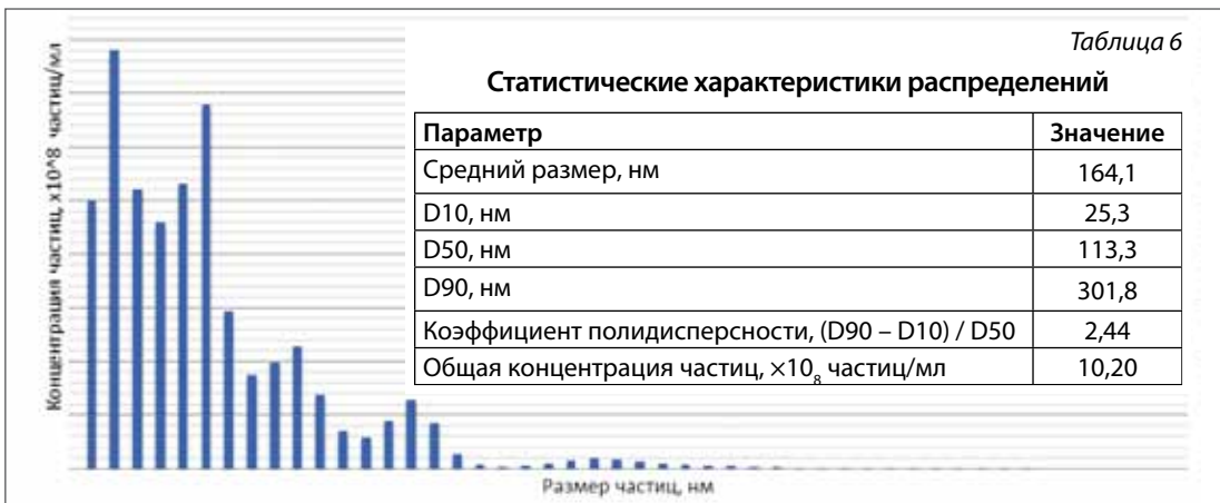
Рис. 7. Распределение частиц по размерам в образце нанокapsул сухого экстракта бадама в гуаровой камеди (соотношение «ядро : оболочка» 1:3)
