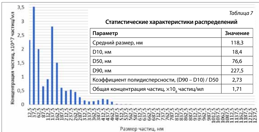
Рис. 8. Распределение частиц по размерам в образце нанокapsул сухого экстракта бадама в каппа-каррагинане (соотношение «ядро : оболочка» 1:1)
