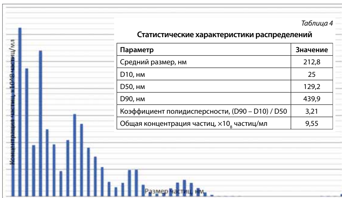
Рис. 5. Распределение частиц по размерам в образце нанокapsул сухого экстракта бадана в гуаровой камеди (соотношение «ядро : оболочка» 1:1)
