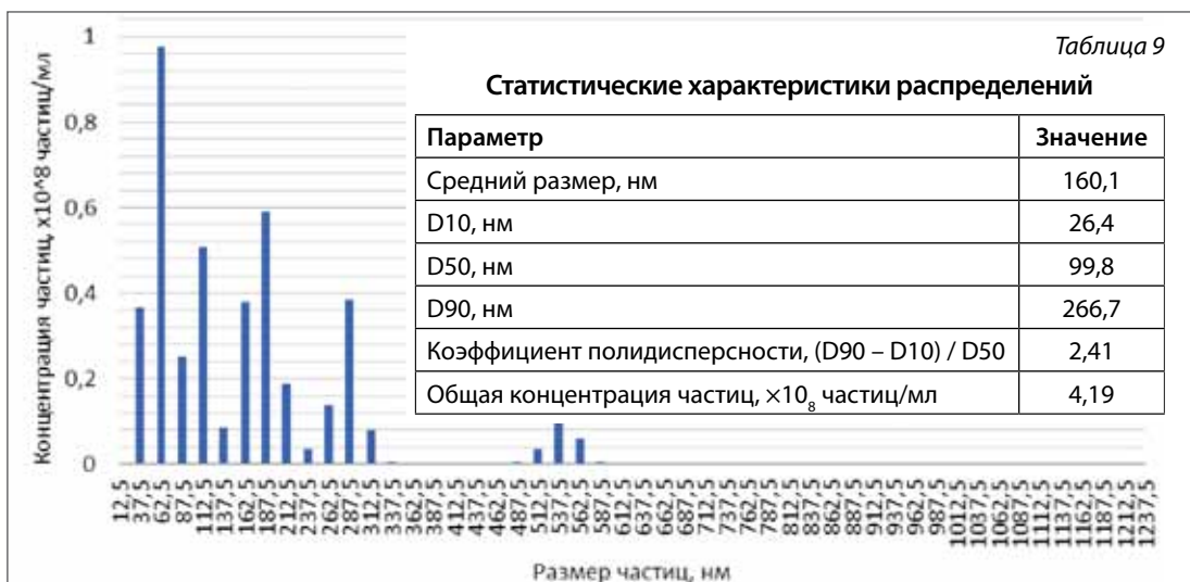
Рис. 10. Распределение частиц по размерам в образце нанокapsул сухого экстракта бадана в kappa-каррагинане (соотношение «ядро : оболочка» 1:3)
