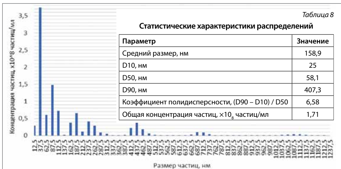
Рис. 9. Распределение частиц по размерам в образце нанокapsул сухого экстракта бадана в kappa-каррагинане (соотношение «ядро : оболочка» 1:2)
