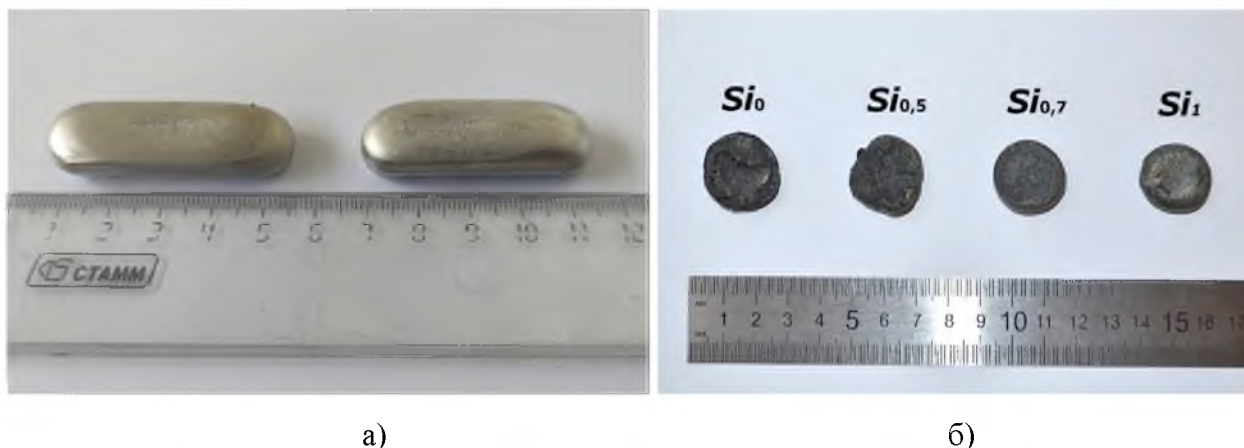
Рис. 1. Внешний вид слитков сплава Co_{63.5}Cr_{29}Mo_5Mn_1W_1C_{0.5} , полученных методом вакуумного дугового переплава (а) и слитки сплавов с различной концентрацией Si (0-1 ат.%), подвергнутые последующей индукционной плавке (б).
