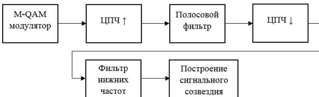
Рис. 1. Функциональная схема первого варианта модели Fig. 1. Functional diagram of the first version of the model
