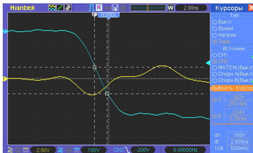
Рис. 2. Осциллограмма для диода 5ДШ402А9: форма волны напряжения – голубая (верхняя), форма тока – желтая (нижняя). Амплитуда импульса обратного напряжения, приложенного через диод V_A=500 В. dV/dt=84 В/нс
