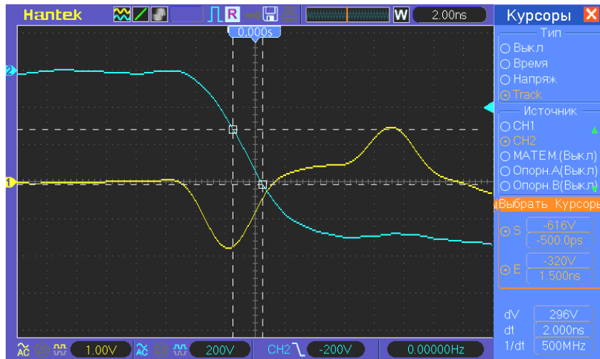
Рис. 3. Осциллограмма для диода 5ДШ402А9: форма волны напряжения – голубая (верхняя), форма тока – желтая (нижняя). Амплитуда импульса обратного напряжения, приложенного через диод V_A=900 В. dV/dt=148 В/нс
