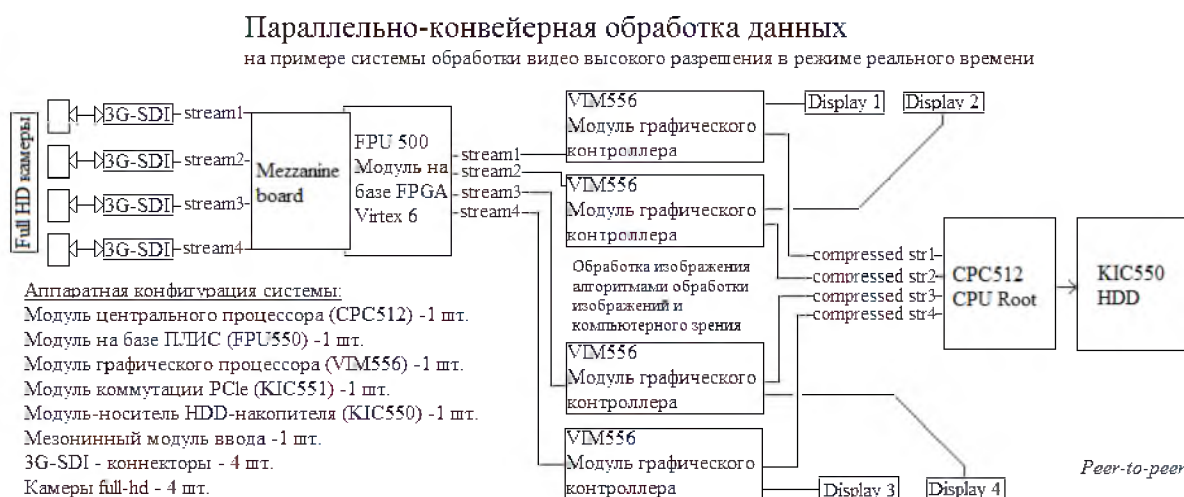
Рис. 2. Параллельно-конвейерная обработка данных на примере системы обработки видео высокого разрешения в режиме реального времени, построенной на базе ВГВП
