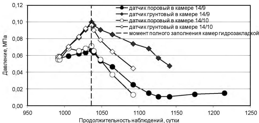
Рис. 1. Изменение полного и порового давления на горизонте -67.5 м в камерах Fig. 1. Changes in total and interstitial chamber pressure at the depth of -67.5 meters
