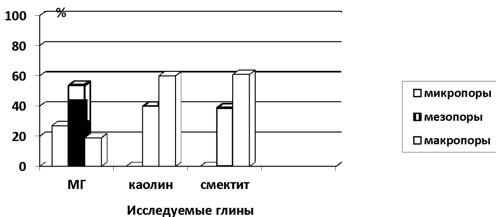
Рис.4. Зависимость вида пор от общего количества пор
