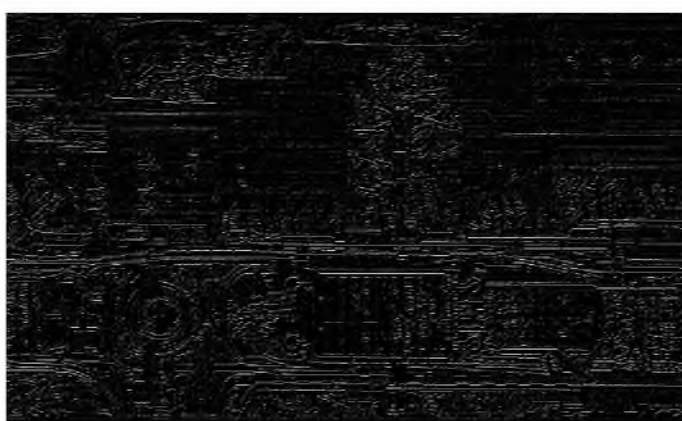
Рис. 6. Невязка с исходным изображением при деконволюции с регуляризацией методом замены нулевого отсчета в спектре –знаменателе при синтезе частотно-контрастной характеристики на значение 0,01
