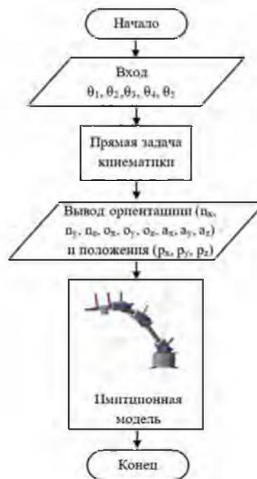
Рис. 6. Блок-схема алгоритма программы прямой задачи кинематики
