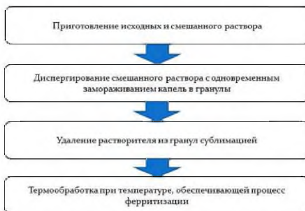
Рис. 4. Блок-схема криохимической технологии.
