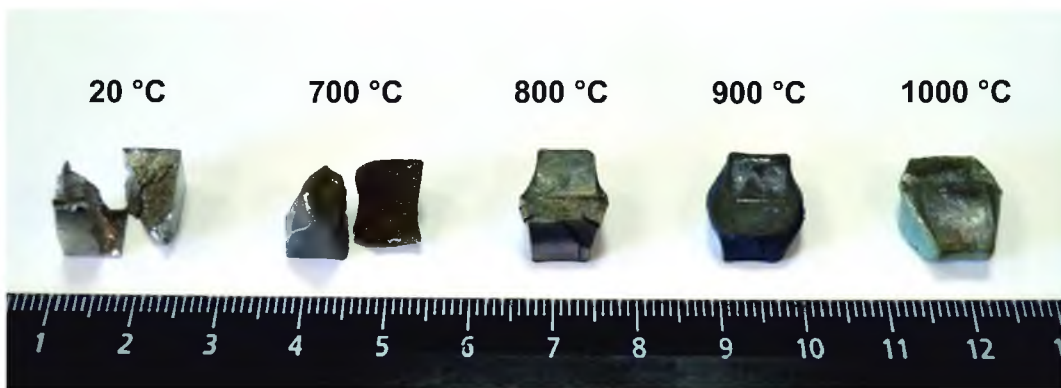
Рис. 3. Внешний вид образцов после осадки литого сплава TNM-B 1 при разных температурах ( \dot{\epsilon}=10^{-3}c^{-1} ).
