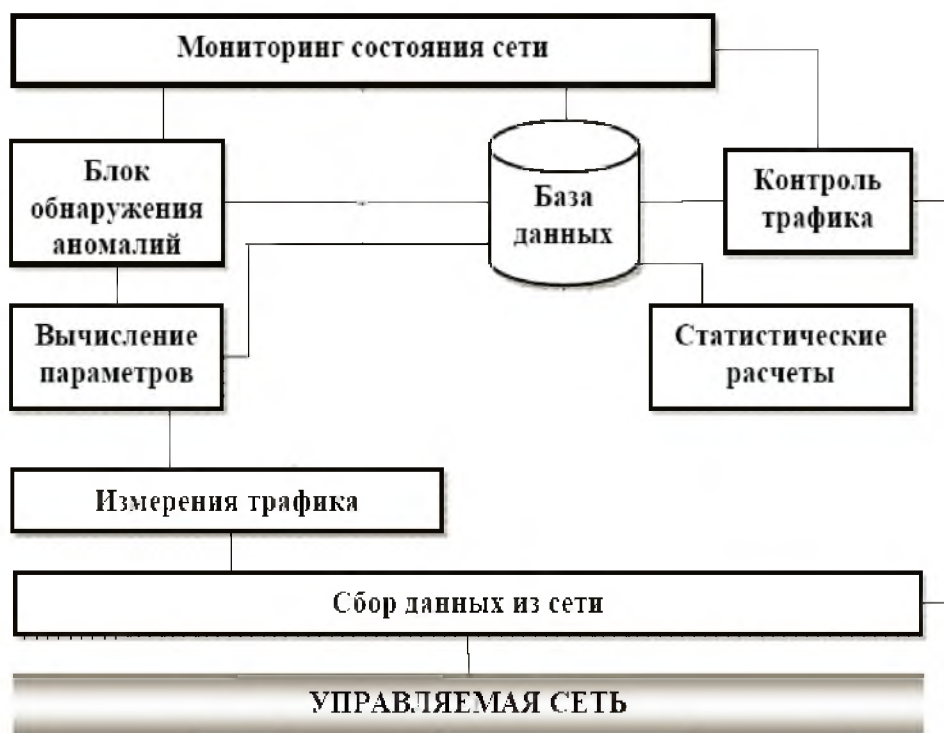
Рис. 6. Функциональная архитектура мультисервисной сети
