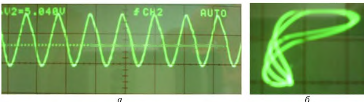
Рис. 7. Результаты исследования физической модели системы при U_n = 8,5 \text{ В} : а – осциллограмма зависимости U_{C_2}(t) ; б – осциллограмма движения изображающей точки на плоскости (U_{C_2}, U_{C_1})
