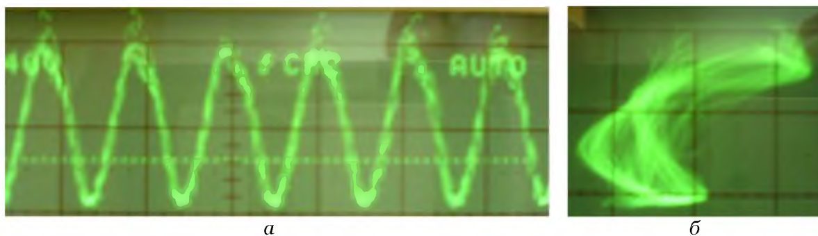
Рис. 8. Результаты исследования физической модели системы при U_n = 10,5 \text{ В} : а – осциллограмма зависимости U_{C_2}(t) ; б – осциллограмма движения изображающей точки на плоскости (U_{C_2}, U_{C_1})
