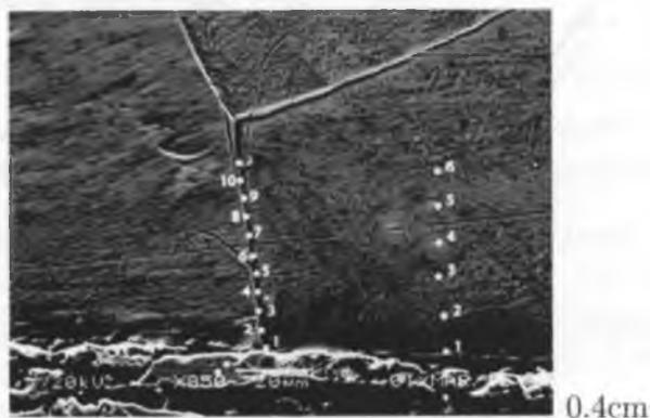
Рис. 1. Микрофотография (РЭМ) поверхности шлифа после травления (белыми точками указаны места МРСА анализа).
