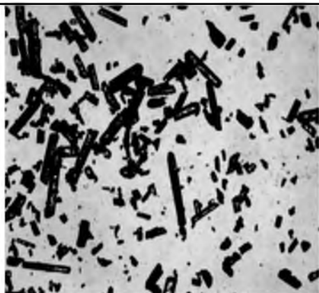
Рис. 3. Микрофотография исходной субстанции таурина (световая микроскопия, 4X)
