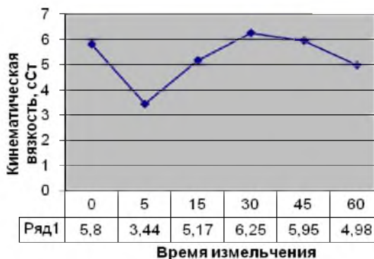
Рис. 26. Зависимость кинематической вязкости водных растворов 1% комбинированного пролонгатора Na-КМЦ и ПВС (1:1) от времени измельчения
