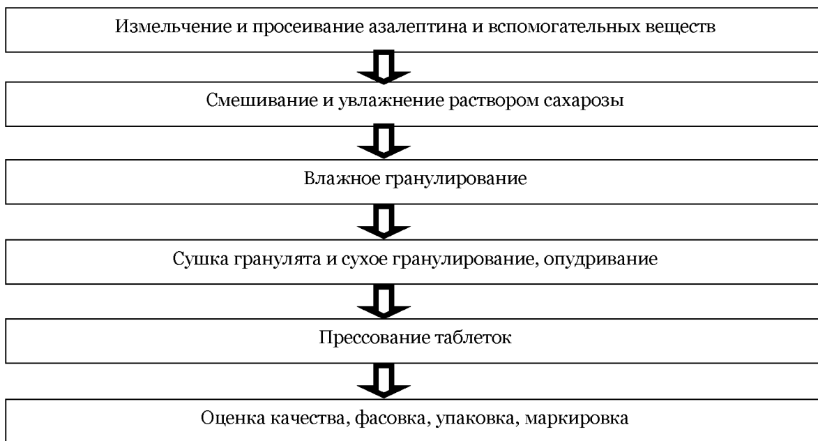
Рис. 2. Технологическая схема производства пролонгированных таблеток азалептина
