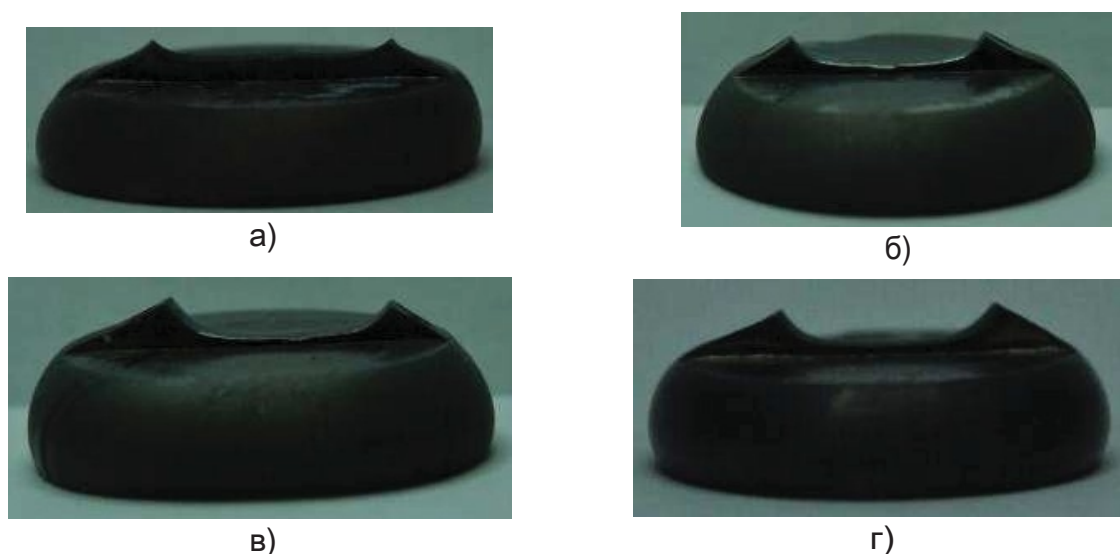
Рис. 4. Заполняемость формы, определенная в ходе осадки на щелевом штампе УМЗ сплава ВТ6 со степенью деформации \epsilon=70\% , \dot{\epsilon}=2 \times 10^{-5} \text{с}^{-1} ; \dot{\epsilon}=2 \times 10^{-4} \text{с}^{-1} (б); \dot{\epsilon}=1 \times 10^{-3} \text{с}^{-1} (в); \dot{\epsilon}=5 \times 10^{-3} \text{с}^{-1} (г).
