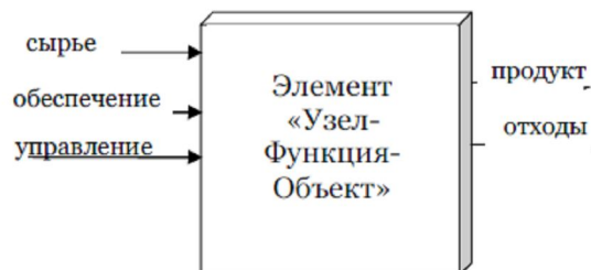
Рис. 2. Графическое представление простейшего элемента системно-объектной модели в пакете «UFO-toolkit»
