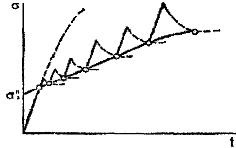
Рис. 11. Определение скорости программного нагружения с помощью ступенчатой релаксации напряжений с выходом на начало установившейся стадии на каждой ступени нагружения: \sigma_0^n – начальное напряжение, выше которого нагружение необходимо вести по данной программе.
