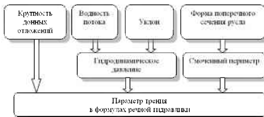
Факторы, определяющие значение параметра трения в формулах речной гидравлики Factors determining the value of the friction parameter in river hydraulics formulas
