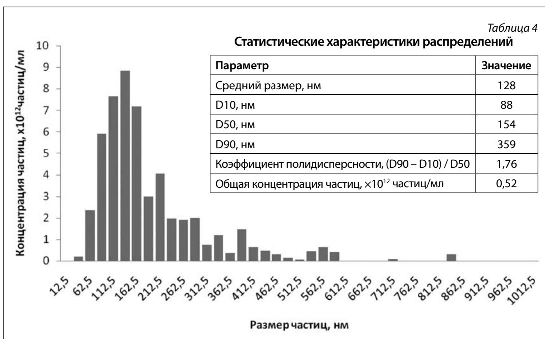
Рис. 5. Распределение частиц по размерам в образце нанокapsул витамина E в альгинате натрия (соотношение «ядро : оболочка» 1:3)
