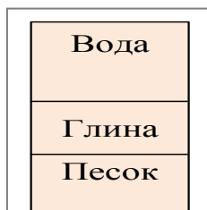
Рис. 2. Схема распределения фракций при отмучивании глины в реакторе Fig. 2. Scheme of distribution of factions in the elutriation of the clay in the reactor
