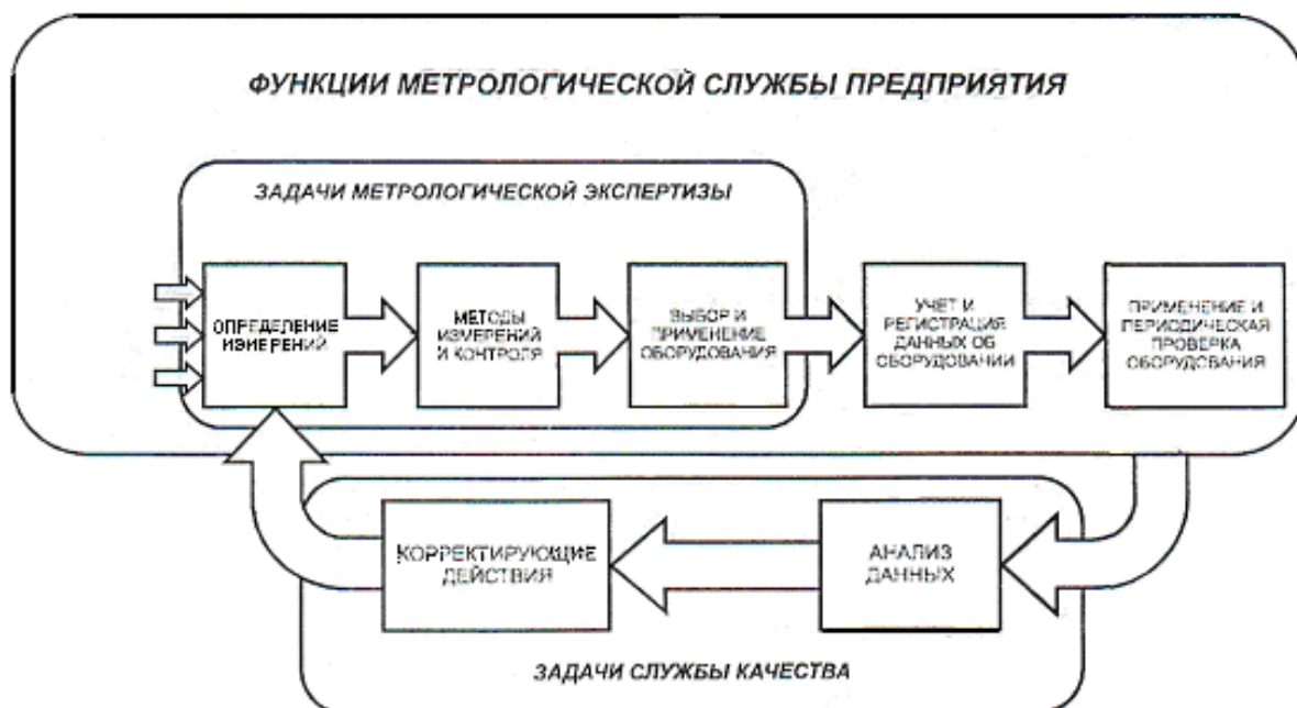
Рис. 2.2. Процедуры управления контрольным, измерительным и испытательным оборудованием
