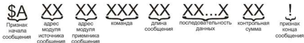
Рис. 3.13. Формат протокола сообщений модулей I-7000 (интерфейс RS-485)
