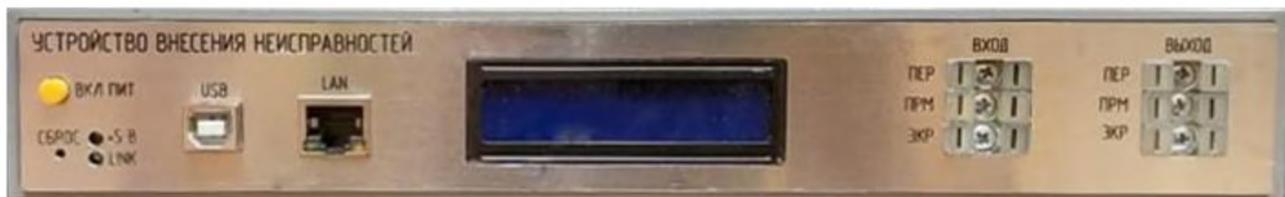
Рис. 1. Внешний вид устройства внесения неисправностей в электрический кабель связи
