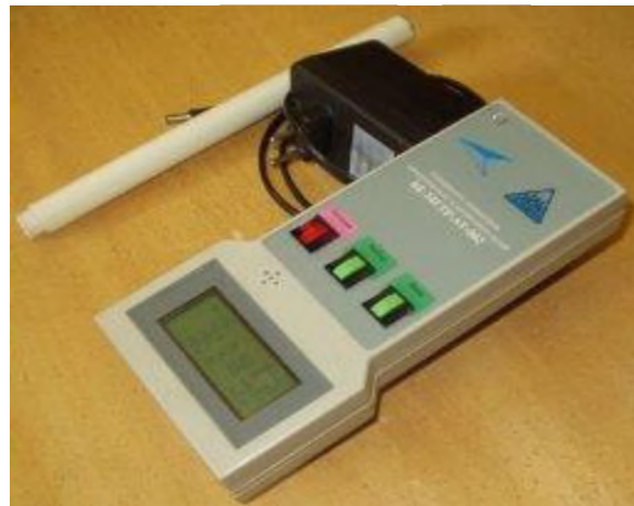
Рис. 3. Измеритель параметров электрического и магнитного полей BE-метр-AT002 Fig. 3. The measurer of electric and magnetic fields parameters BE-meter-AT002
