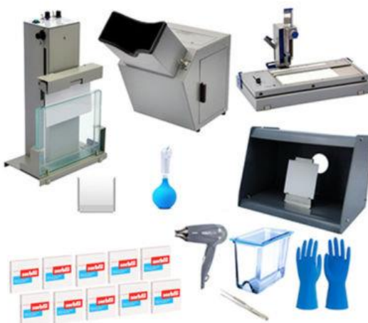
Рис. 3.1. Материалы и оборудование для тонкослойной хроматографии
