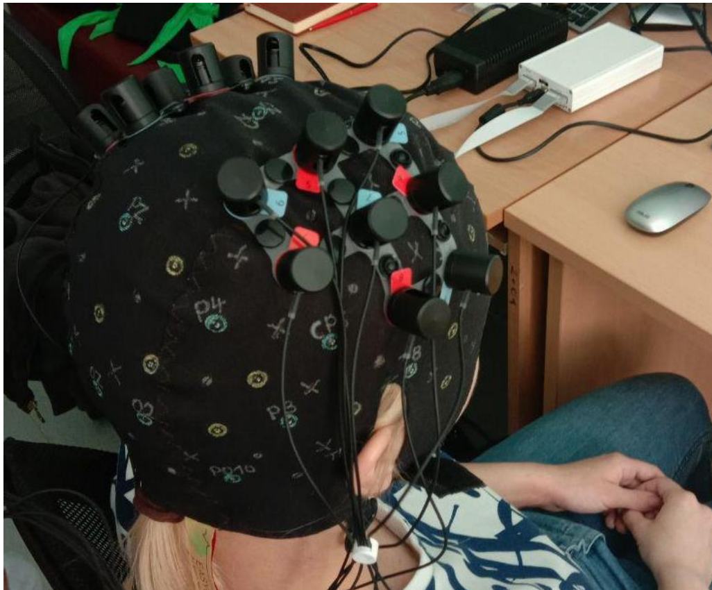
Рисунок 3.1 – Оптоды и детекторы устройства
