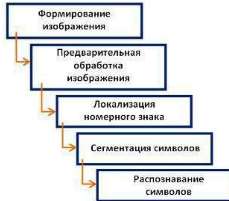
Рисунок 3.1 - Общая структура типовой системы номерных знаков
