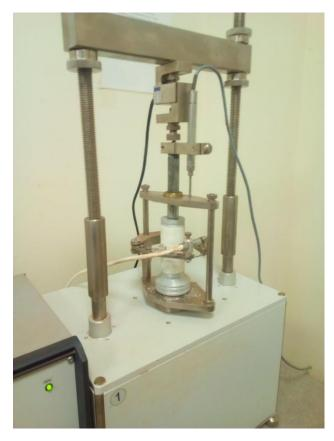
Рис. 2.2 – Установка одноосного сжатия
