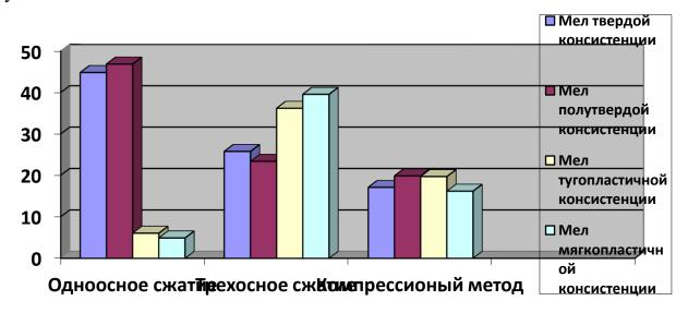
Рисунок 2.12 — Диаграмма зависимости модуля общей деформации от консистенции мела
