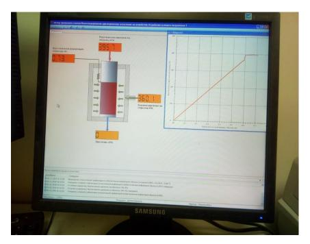
Рис. 2.4 – Монитор ПК в момент испытаний методом на трехосное сжатие
