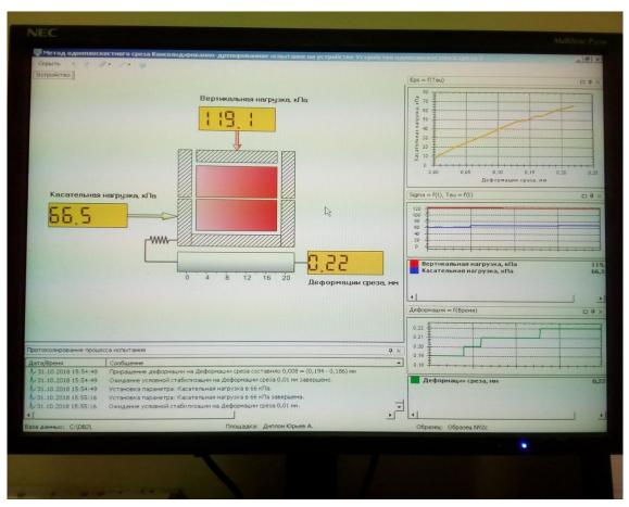
Рисунок 2.1 — Монитор ПК в момент испытаний методом одноплоскостного среза
