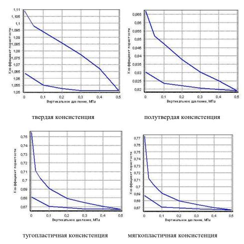
Рисунок 2.9 – Компрессионные кривые для мела разной консистенции
