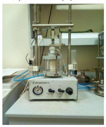
Рис. 2.5 - Стабилометр
