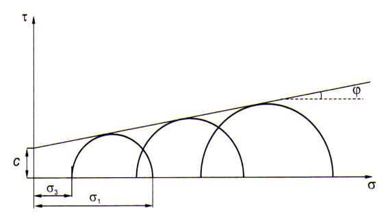
Рисунок 2.7 – Круги Мора-Кулона и прямая предельного состояния
