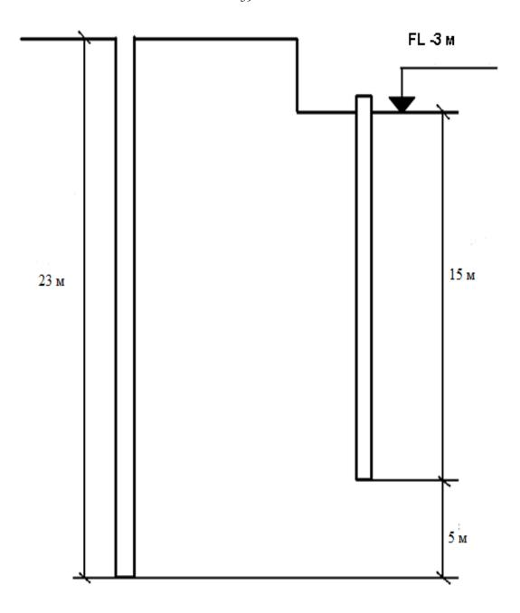
Рисунок 3.5 — Схема определения глубины бурения здания при использовании свай
