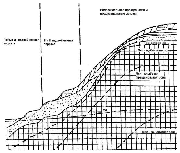
Рисунок 1.7 – Геоморфологическая схема с выделенными слоями и зонами меловых отложений г. Белгорода
