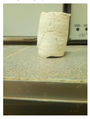
Рисунок 2.6 – Разрушенный образец мела
