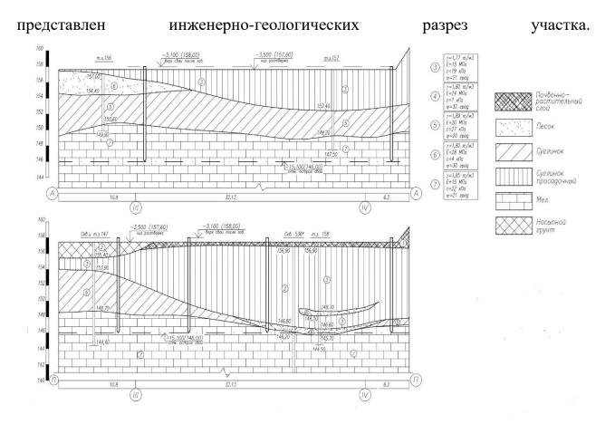
Рисунок 3.2 – Инженерно-геологический разрез участка строительства
