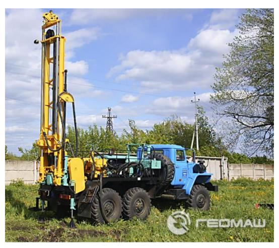
Рисунок 3.3 – Буровая установка ПБУ-2
