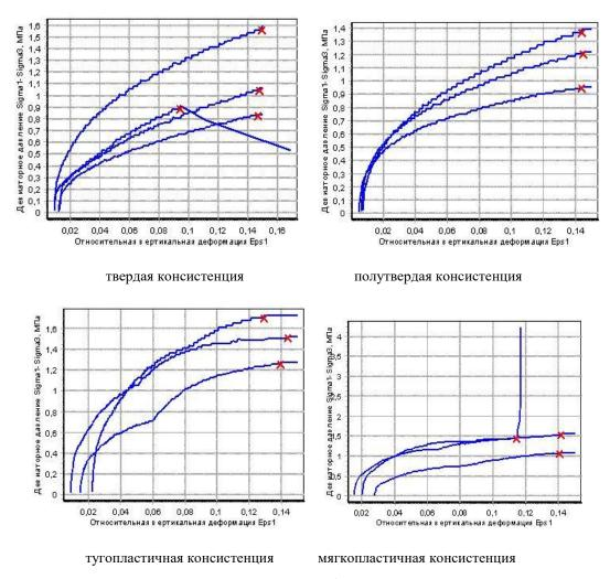
Рисунок 2.10 – Зависимости стабилометрических испытаний
