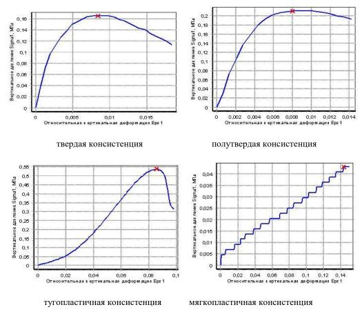
Рисунок 2.11 – Зависимости одноосных испытаний
