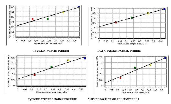
Рисунок 2.14 – Графики сдвига для мела различной консистенции
