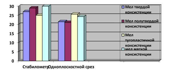
Рисунок 2.17 — Диаграмма зависимости угла внутреннего трения от консистенции мела
