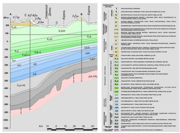
Рисунок 1.2 – Геологический разрез по линии А-Б
