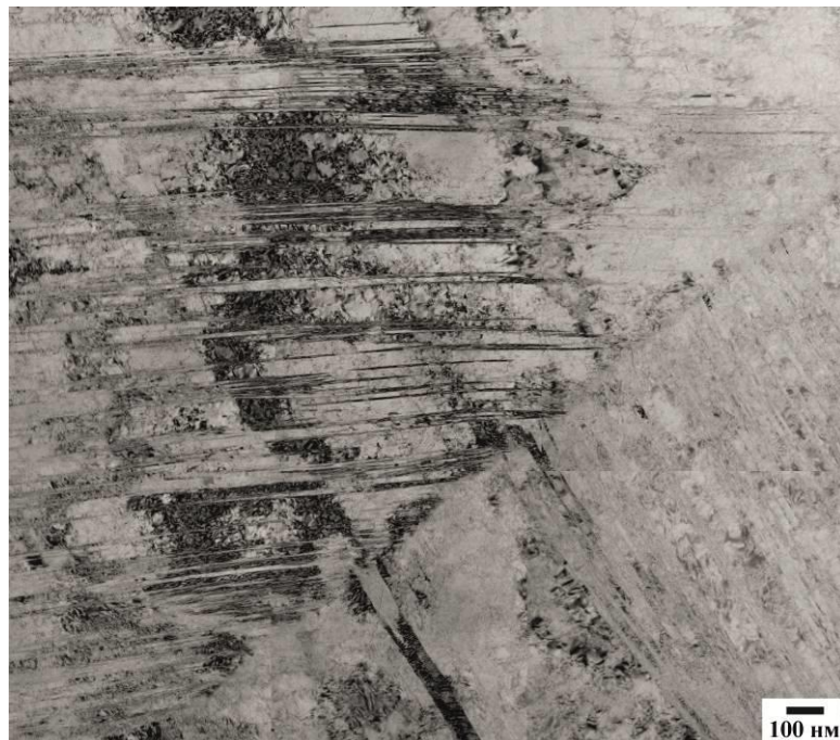
Рис. 3.8 Панорамное изображение микроструктуры стали после осадки на степень деформации 0,4
