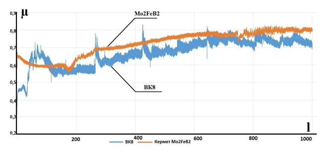
Рис. 3.7 График зависимости коэффициента трения от пути для  $Mo_2FeB_2$  (оранжевый) и BK8 (синий) при  $600~^0C$
