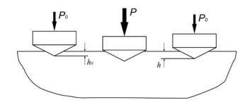
Рис. 2.1 Метод определения твердости по Роквеллу [22]
