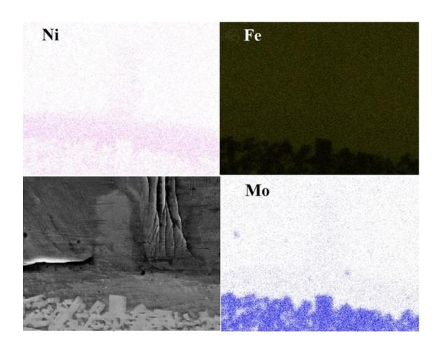
Рис. 3.13 Изображение напайного соединения и карты распределения элементов в нем. Область протекания процесса жидкометаллического смачивания.
