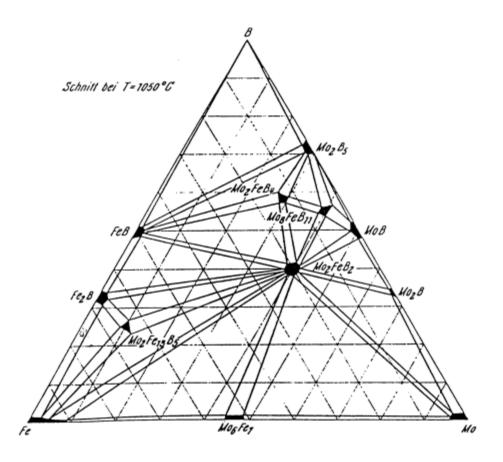
Рис. 1.2 Диаграмма состояния системы Mo-Fe-B при 1050°C [11]
