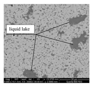
Рис. 3.6 Микроструктура кермета системы Mo<sub>2</sub>FeB<sub>2</sub>-Fe, на которой видны области свободные от частиц боридов (liquid lake)
