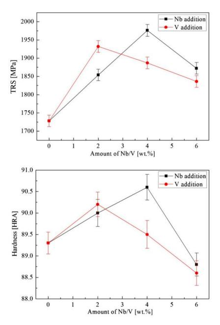
Рис. 1.6 Зависимость предела прочности на изгиб и твердости от содержания ниобия и ванадия [15].
