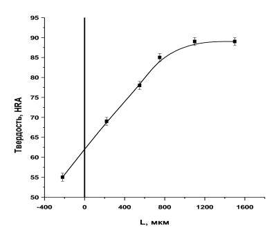
Рис. 3.15 Изменение твердости в зависимости от расстояния от места контакта кермет-сталь. Линией отмеченая граница между сталью и керметом.
