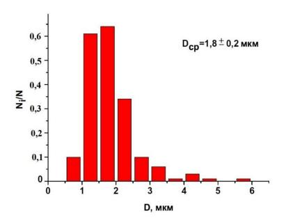
Рис. 3.17 Структура кермета системы Mo<sub>2</sub>FeB<sub>2</sub>-Fe и гистограмма частиц боридов в объеме кермета на расстоянии от напайного соединения
