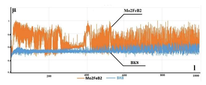
Рис. 3.8 График зависимости коэффициента трения от пути для  $Mo_2FeB_2$  (оранжевый) и BK8 (синий) при  $800^{\circ}C$
