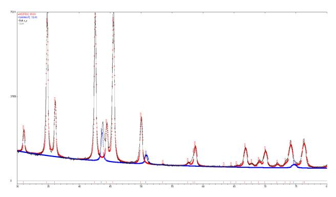
Рис. 3.1 Рентгенограмма кермета системы Мо-Fe-В
