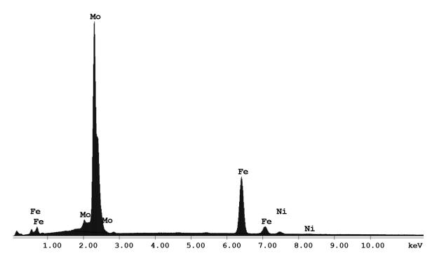
Рис. 3.3 Энергодисперсионный спектр, соответствующий частицам борида  $\label{eq:Mo2FeB2} Mo_2 FeB_2$
