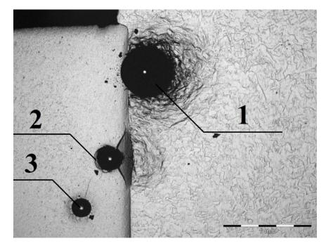
Рис. 3.14 Отпечатки индентора после проведения испытания на твердость методом Роквелла
