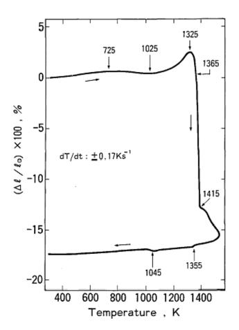
Рис. 1.4 Изменение размеров образца сплава Fe-6B-48Mo в процессе спекания [10]
