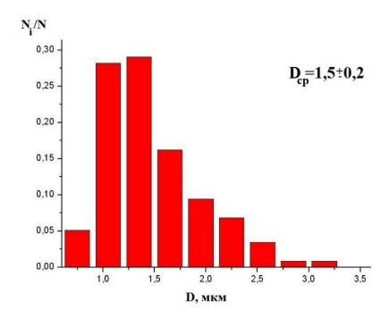
Рис. 3.5 Микроструктура кермета системы  $Mo_2FeB_2$ -Fe и гистограмма частиц боридов в исходном состоянии
