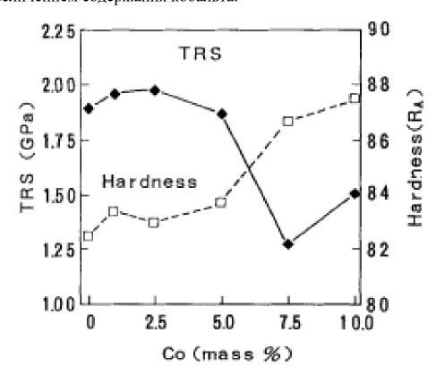
Рис. 1.5 Зависимость предела прочности на изгиб и твердости от содержания кобальта [14].
