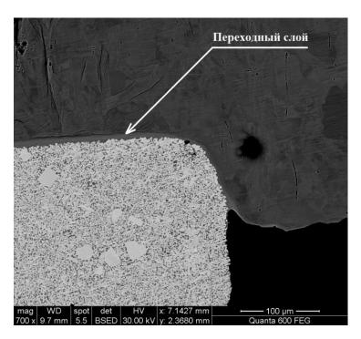
Рис. 3.10 Шов напайного соединения
