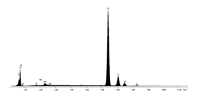
Рис. 3.11 Энергодисперсионый спектр, соответствующий области переходного слоя.
