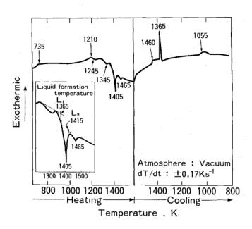
Рис. 1.3 Кривая дифференциального термического анализа для циклов нагрева и охлаждения сплава Fe-6B-48Mo [10]
