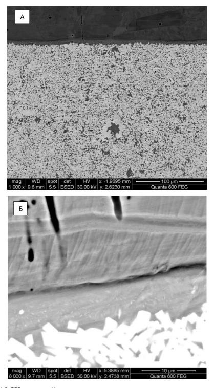
Рис. 3.12 Шов напайного соединения при различных увеличениях
