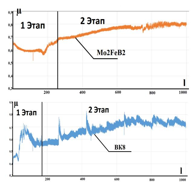
Рис. 3.9 Этапы изнашивания  $Mo_2FeB_2$  (а) и BK8 (б) при  $600^{\circ}C$
