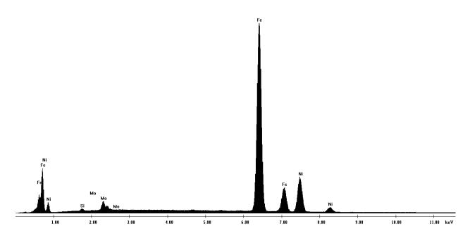
Рис. 3.4 Энергодисперсионный спектр, соответствующий связке
