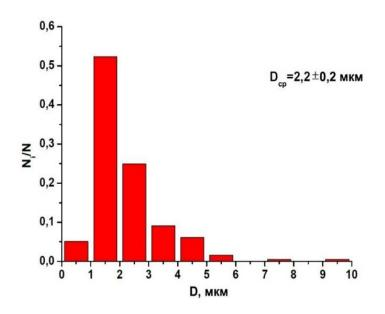
Рис. 3.18 Структура кермета системы Mo<sub>2</sub>FeB<sub>2</sub>-Fe и гистограмма частиц боридов в объеме кермета вблизи напайного соединения
