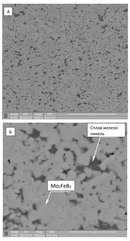
Рис. 3.2 Микроструктура кермета  $Mo_2FeB_2$ -Fe
