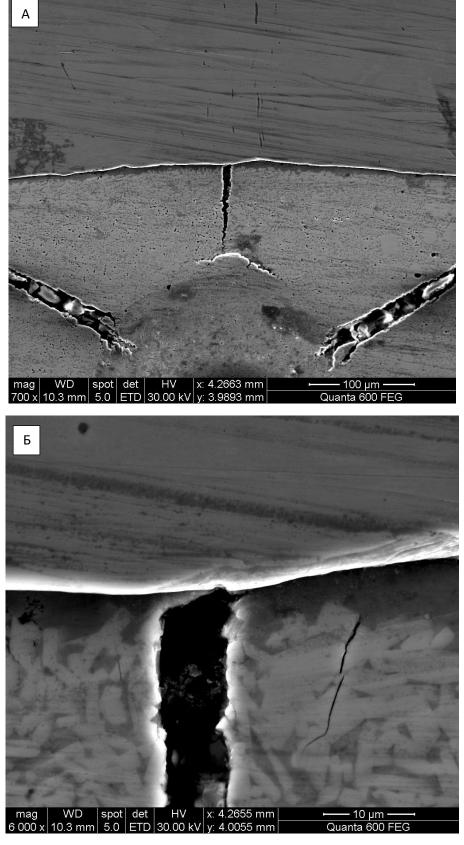
Рис. 3.16 Распространение трещин в области вдавливания индентора
