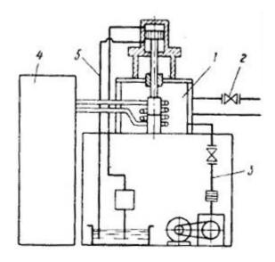
Рис. 1.1 Установка для диффузионной сварки
