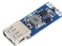
Рисунок 13 – DC-DC преобразователь
