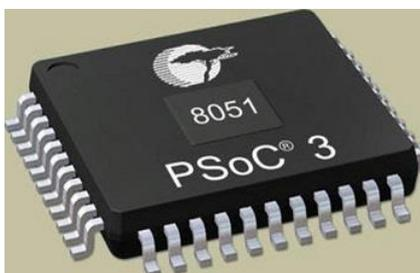
Рисунок 4 – Микроконтроллер 8051
