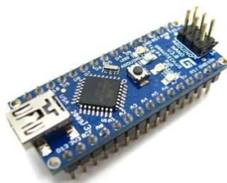
Рисунок 9 - Arduino Nano
