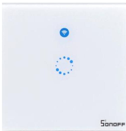
Рисунок 3.4.1 - Внешний вид однокнопочного выключателя освещения “Sonoff T1”
