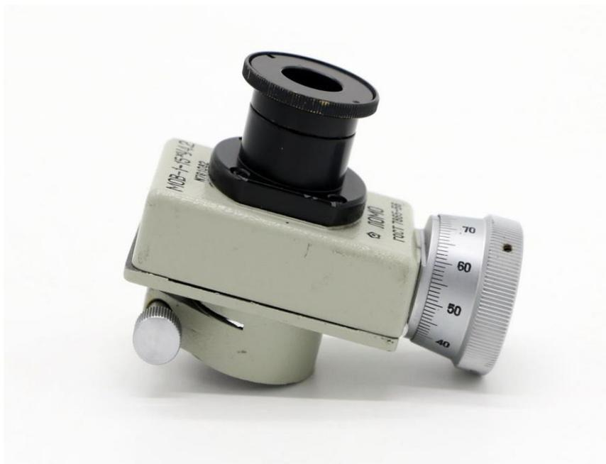
Рис. 2.5. Микрометр МОБ-1-15
