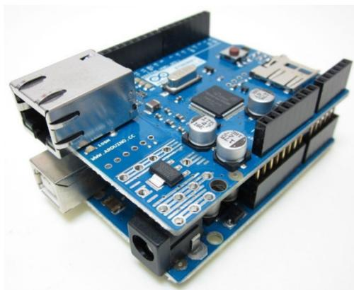
Рисунок 23 –Подключенный Ethernet Shield к Arduino
