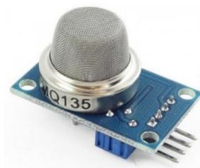
Рисунок 20 – Датчика качества воздуха MQ135
