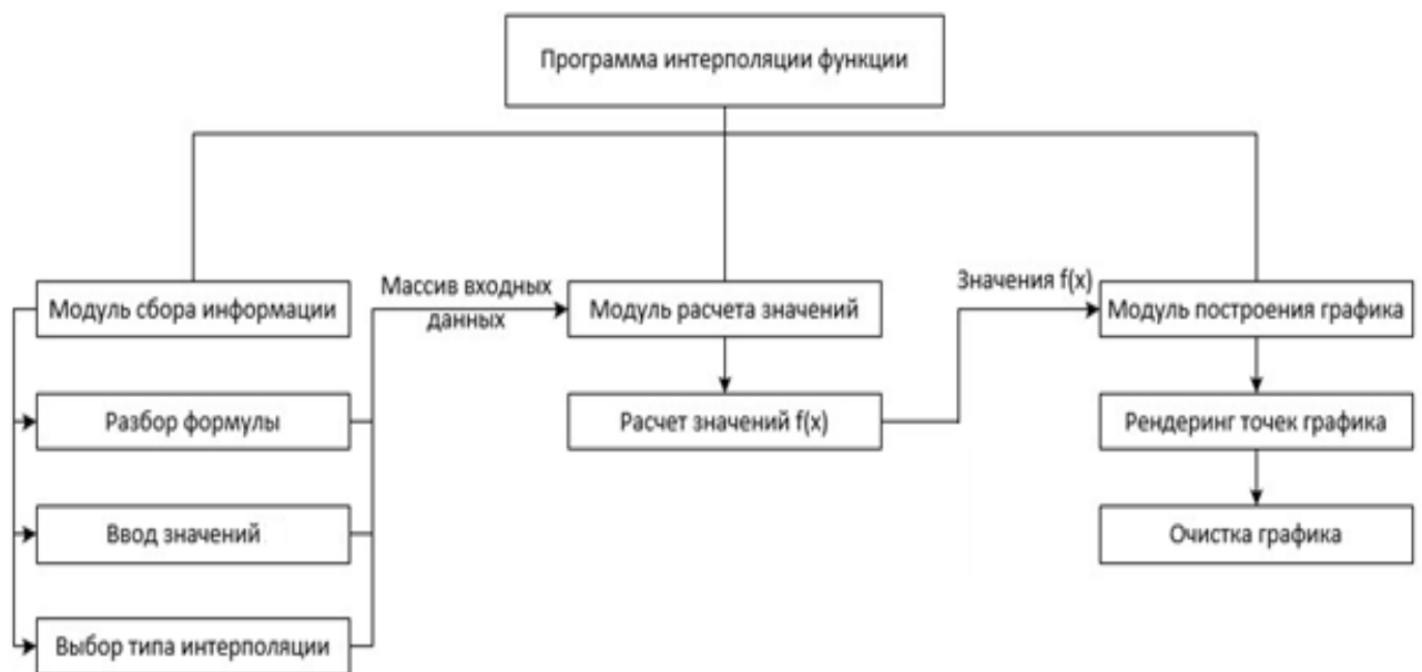
Рис. 2.8. Модульная схема приложения
