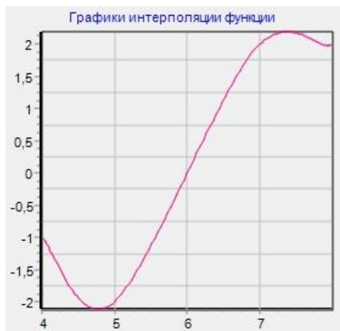
Рис. 3.20. Интерполяция сплайном Катмулла-Рома
