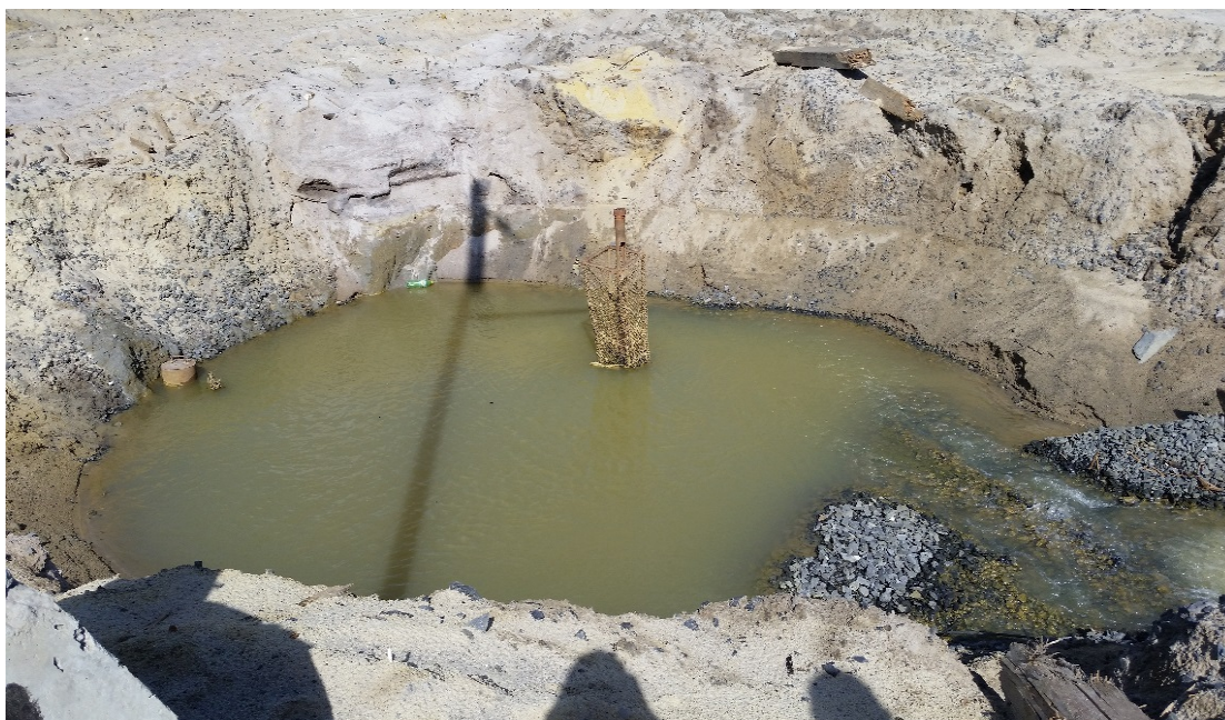
Рисунок 2.3.2—Водосборная скважина с зумпфом-отстойником на +93 горизонте
