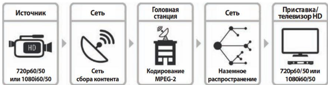
Рисунок 13 - Типовой технологический процесс HD- вещания на базе MPEG-2
