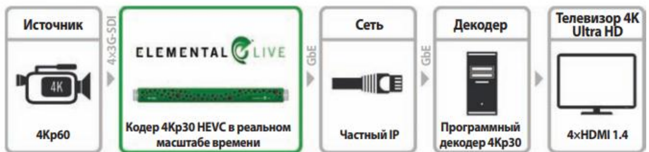
Рисунок 14 – Рабочий процесс первой прямой трансляции в формате 4Kp30
