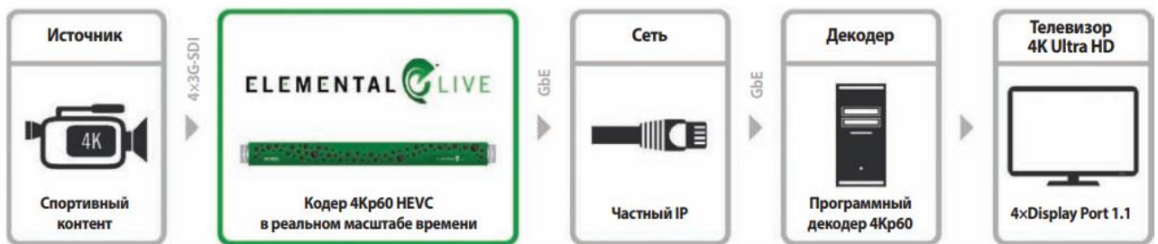
Рисунок 16 – Рабочий процесс первой прямой трансляции в формате 4Кр60
